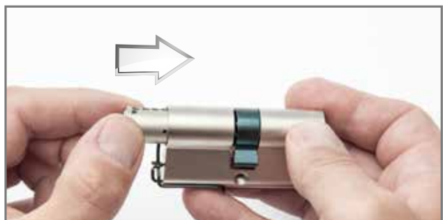
Bestifteten Kern gerade einschieben Insert the core straightly Insérez le rotor avec les goupilles tout droit
